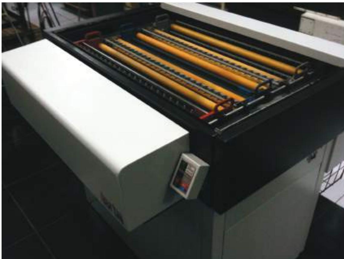
*(processo de revelação pelos tambores, revelador fixador e água)*
